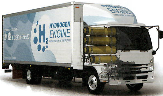
水素化コンバージョンでは、水素に適したエンジンの改造に加え、既存の燃料供給部品を水素タンクをはじめとする高圧水素に適合した各種部品に変更する
