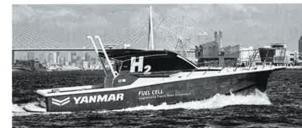
船用水素燃料電池システムを搭載した実証試験艇(出所:ヤンマーホールディングス)
