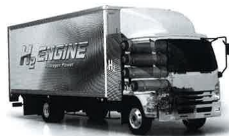
水素化コンバージョン技術のイメージ。ディーゼルエンジンの部品と燃料供給系部品を水素燃料用部品に交換する(出所:iLabo)
