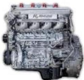
地球温暖化対策として世界的な脱炭素化が進む中、非化石燃料パワートレーンのもう一つの選択肢である水素エンジンを通して産業領域における脱炭素化の早期実現を目指す i Labo は、水素エンジン研究の実績をもとに、部品交換、制御変更等による既存のディーゼルエンジン搭載トラックを、水素を燃料として稼働するエンジン置換する「水素化コンバージョン」普及促進の為、R&D センターの水素専用エンジンベンチにて水素エンジンの開発を進めております。この技術を通し、
